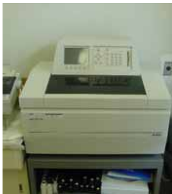
液体シンチレーションカウンタ
