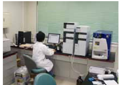
液体クロマト質量分析装置 LC/MS/MS 日本ウォーターズ Quattro micro API
