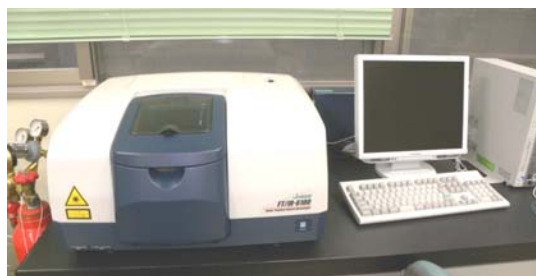
フーリエ変換赤外分光光度計 日本分光株式会社 FT/IR-6100
